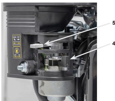
6. Mettre l'interrupteur du moteur en position MARCHÉ.
