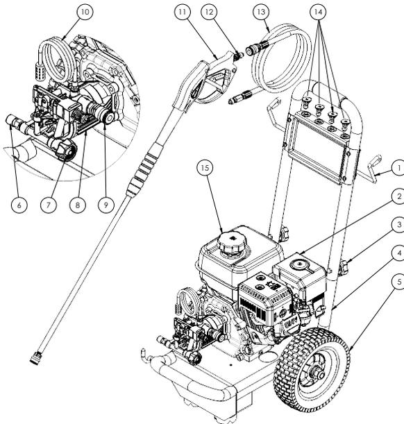
1. Crochet de cadre: Rangement pour le boyau de la laveuse haute pression ou la lance du pistolet de pulvérisation.
